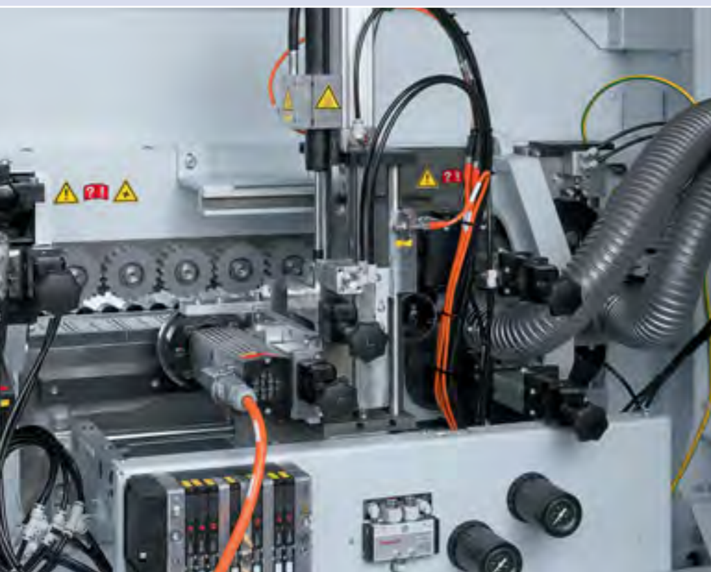
Formfräsaggregat (Highflex 1430) Optimales Formfräsen ohne Einstellarbeiten durch Kopplung von DIA-Werkzeug und Tastrolle. Werkstückdicke 40 mm.
