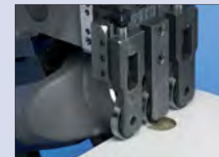
Nesting Paket (optional) Bestehend aus einer Mehrfach-Tastung auf Fräs- und Ziehklängenaggregat zur Überbrückung von z.B. Topfbandbohrungen.
