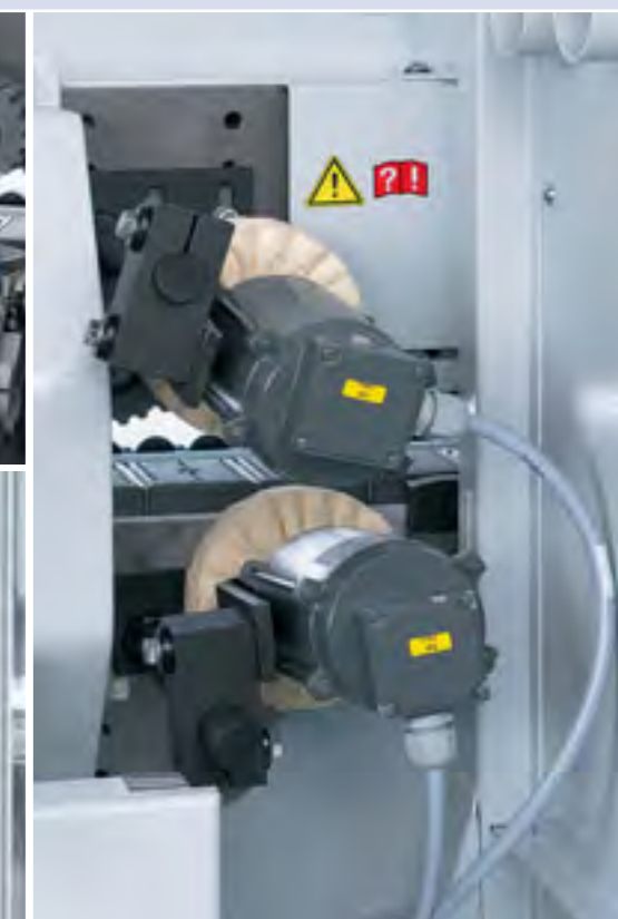
Schwabbelaggregat Zum Polieren von Kanten für natürliche Farbtreue.
