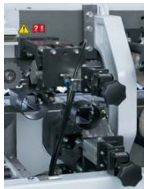
Ziehklingenaggregat Zum Glätten von Radien oder Fasen (optionale Verstellung mittels Pneumatik möglich).
