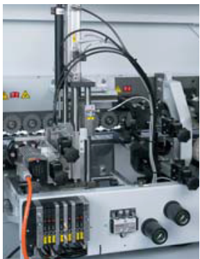
Formfräsaggregat Optimales Formfräsen ohne Einstellarbeiten durch Kopplung von DIA-Werkzeug und Tastrolle.
