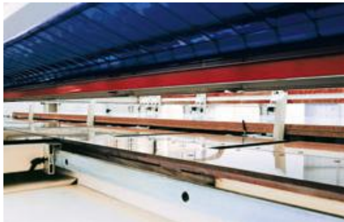
Allineatori frontali per il carico automatico
