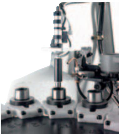
Sistema di lettura del chip integrato nel portautensili per il riconoscimento automatico degli utensili.
