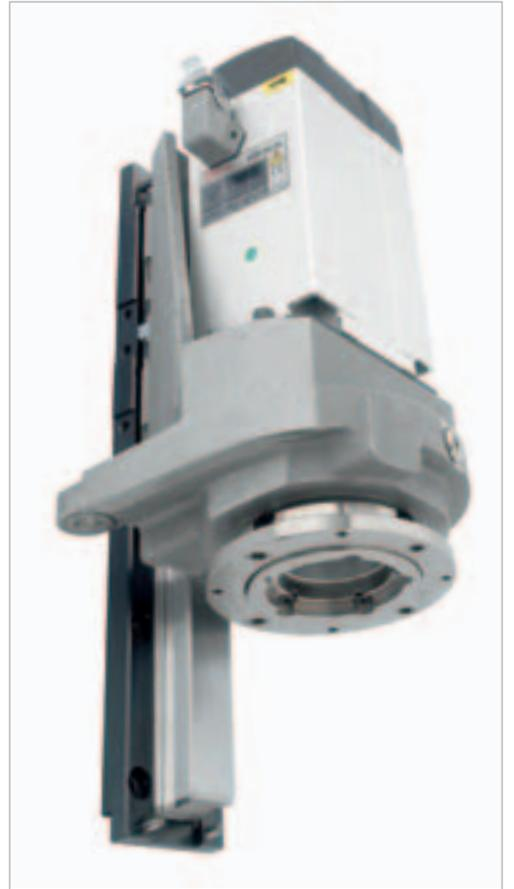
Il gruppo multifunzione può ospitare aggregati per l'esecuzione di lavorazioni specifiche (incasso per serratura, sedi per cerniere, foratura orizzontale profonda, intestatura, ecc.). In base alle necessità di impiego è possibile scegliere tra un gruppo con posizione fissa, uno orientabile 0°-90°, uno inclinabile 0°-180° oppure un gruppo posizionabile in continuo su 360° da CN.
