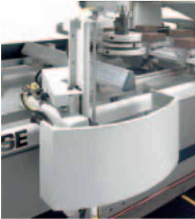
Pick Up è un magazzino supplementare a bordo basamento che permette di alloggiare utensili o aggregati di grandi dimensioni. Consente anche di attrezzare gli altri magazzini.
