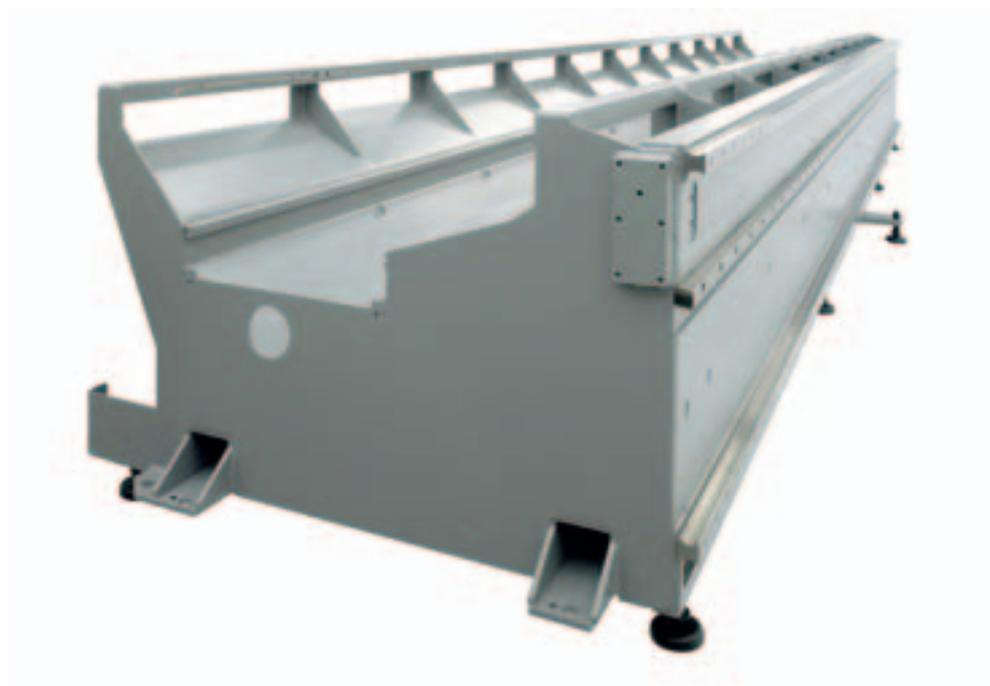
Il basamento è costituito da un unico componente in carpenteria elettrosaldato con lamiere d'acciaio di elevato spessore ed è opportunamente irrigidito nei punti maggiormente sollecitati.
