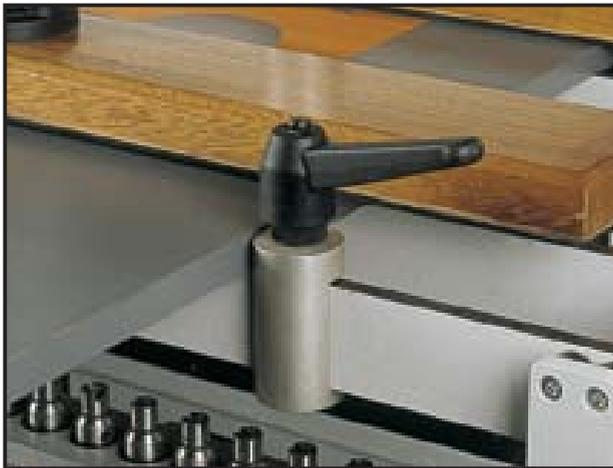
Anschlag zur Führung von langen Werkstücken während einer Querbohrung
