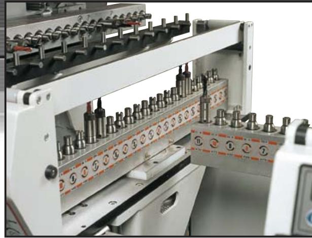
Positionierung des 1. vertikalen Bohrkopfes zum Einbohren von Verbindungsbeschlägen in den Seiten; Positionierung des 2. vertikalen Bohrkopfes bei 90° zur Bohrung einer mittleren Lochreihe zum Einsetzen von Mittelböden oder Kleiderstangen
