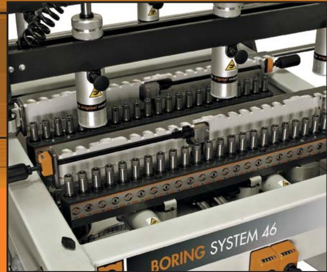
Unsere Unfallsichere Druckvorrichtungen verhindern, dass der Bediener sich die Haende verletzt. Sie ermoeglichen die sofortige Positionierung eines zu bearbeitenden Stuecks jeglicher Staerke, durch einfaches Knopfziehen.
